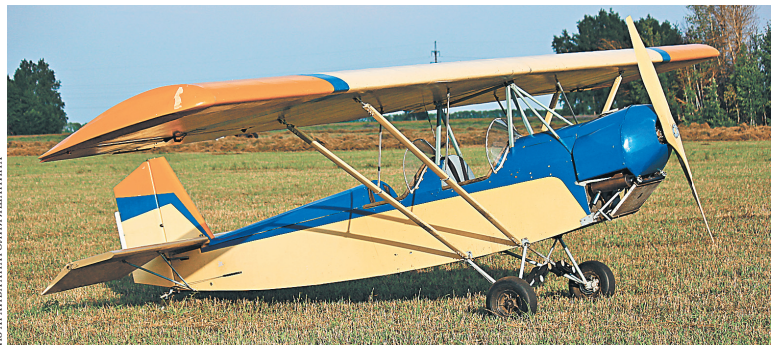
Сборка легких деревянных самолетов—семейное увлечение Яшаниных. Максимальная скорость—около 190 километров в час, крейсерская—120.
