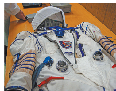
Костюм для «солнцелета», созданный на НПП «Звезда», соединил достоинства «Сокола» и «Орлана».
