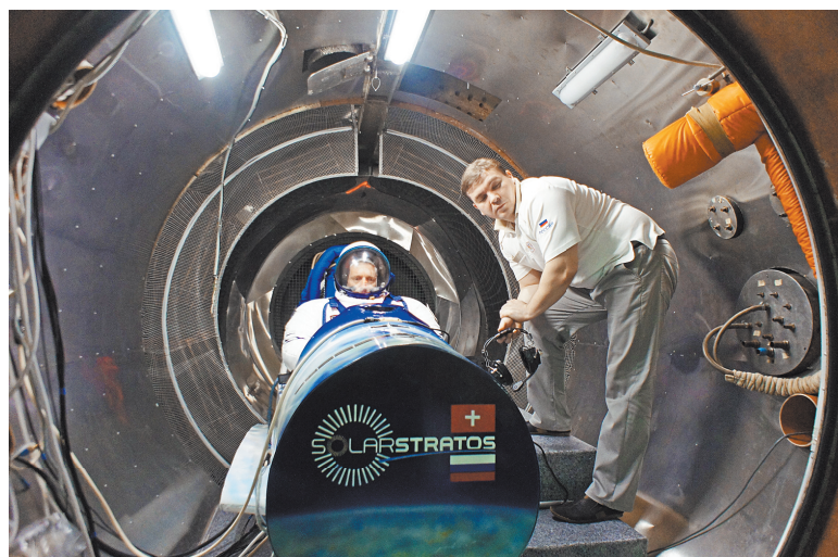
В термобарокамере скафандр Рафаэля подключили к системам жизнеобеспечения.
